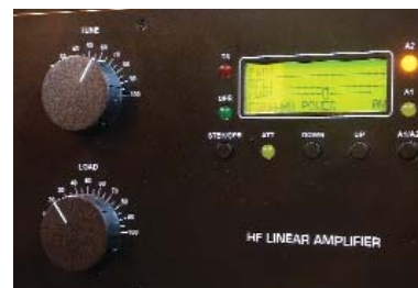
Gesamtansicht der PA ALPIN 200 (Abmessungen B x H x T = 470 mm x 200 mm x 460 mm einschließlich 42 mm Lüfterüberstand)
