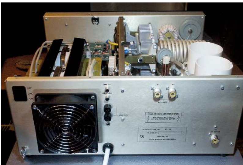
Rückansicht und Kühlluft-Eintritt
