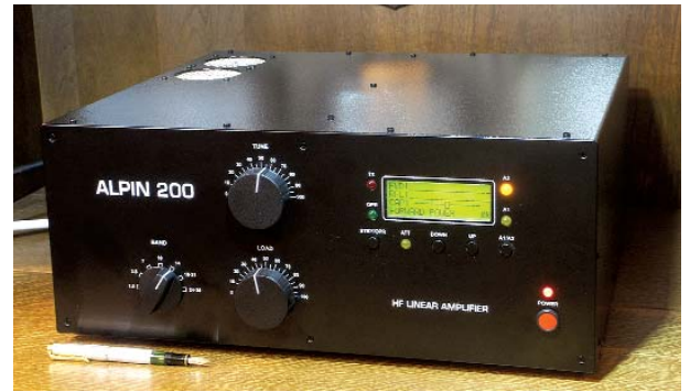
Gesamtansicht der PA ALPIN 200 (Abmessungen B x H x T = 470 mm x 200 mm x 460 mm einschließlich 42 mm Lüfterüberstand)
