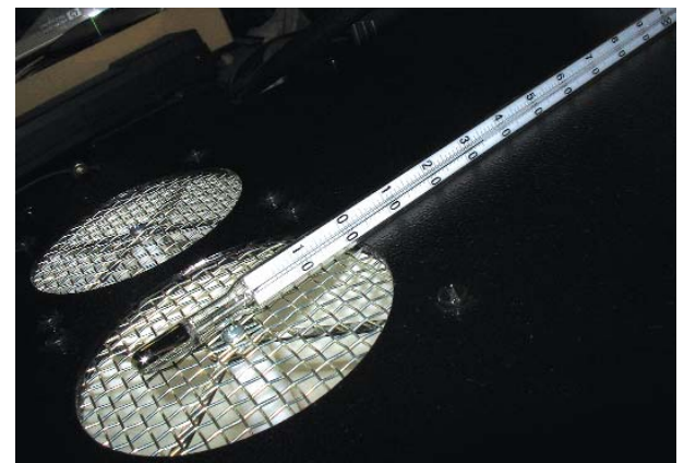
Die gemessene Stand-by-Temperatur am Luftauslass beträgt ca. 35 °C
