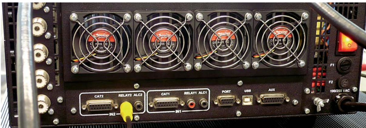
Bild 14: Teilansicht der Geräte-rückseite mit den Daten-Schnittstellen
